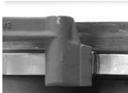
Figur 2-19: Böja BAND-IT® verktyg över fasthållningsklämma
