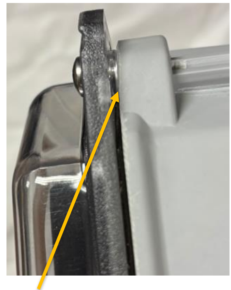
Axeln vidrör hörnflänsen av SÄNDARENS höljes bas
