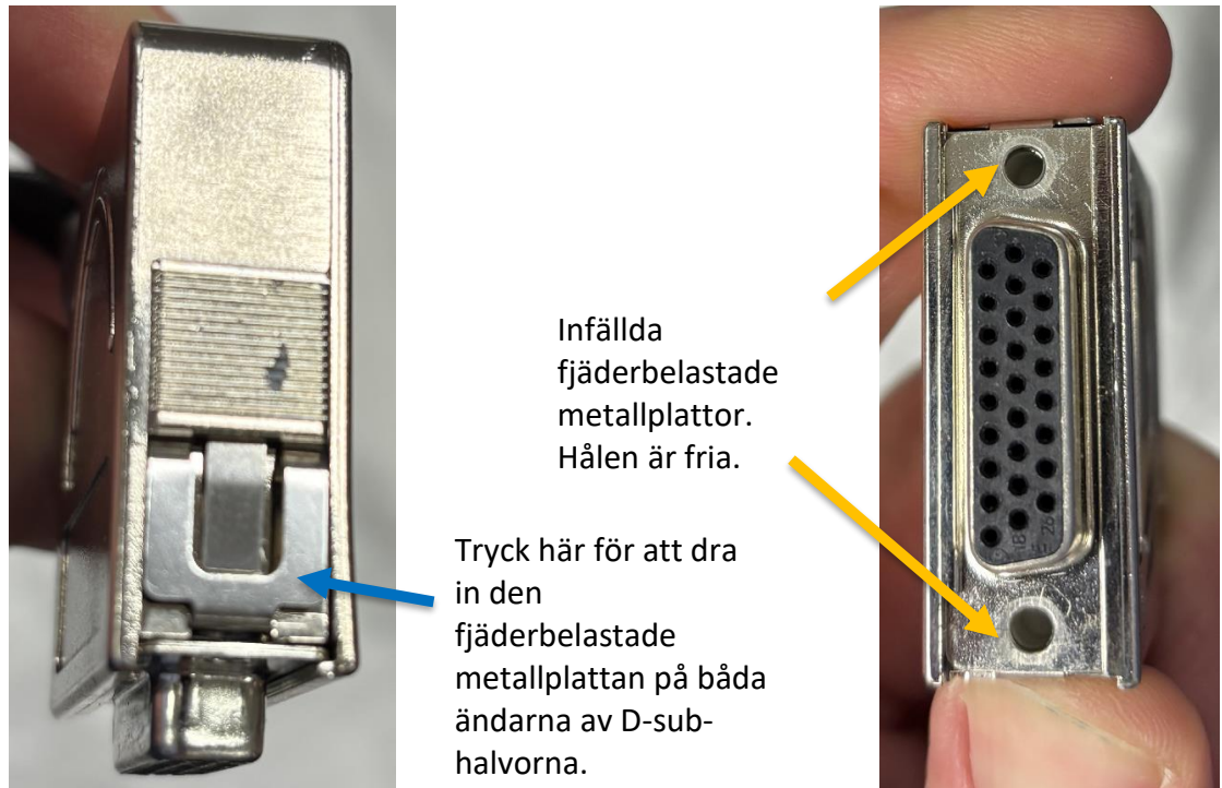
Figur 2-29: Isärkoppling av D-sub-kontakter
