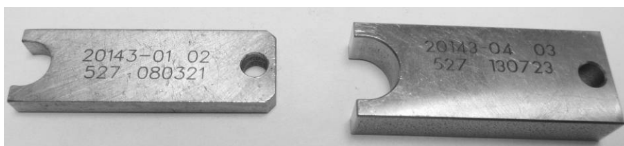
Наиболее распространенные приспособления для установки зазора стяжного хомута Номер детали 20143-01 (слева) и номер детали 20143-04 (справа)
