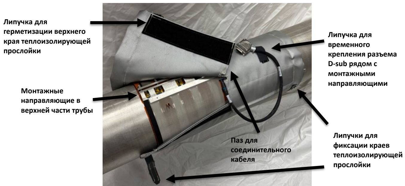
Рис. 2-13: Установка теплоизолирующей прослойки поверх ХОМУТА для труб диаметром от 6 до 30 дюймов
