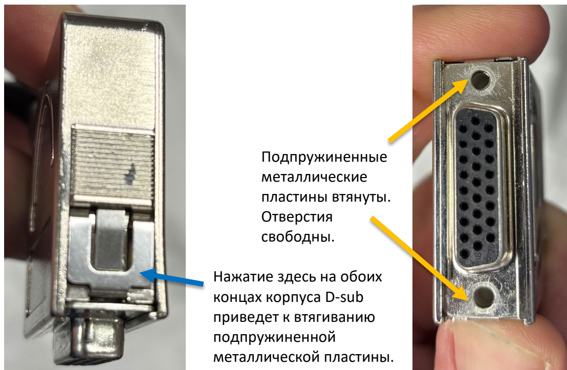
Рис. 2-29: Отсоединение разъемов D-sub
