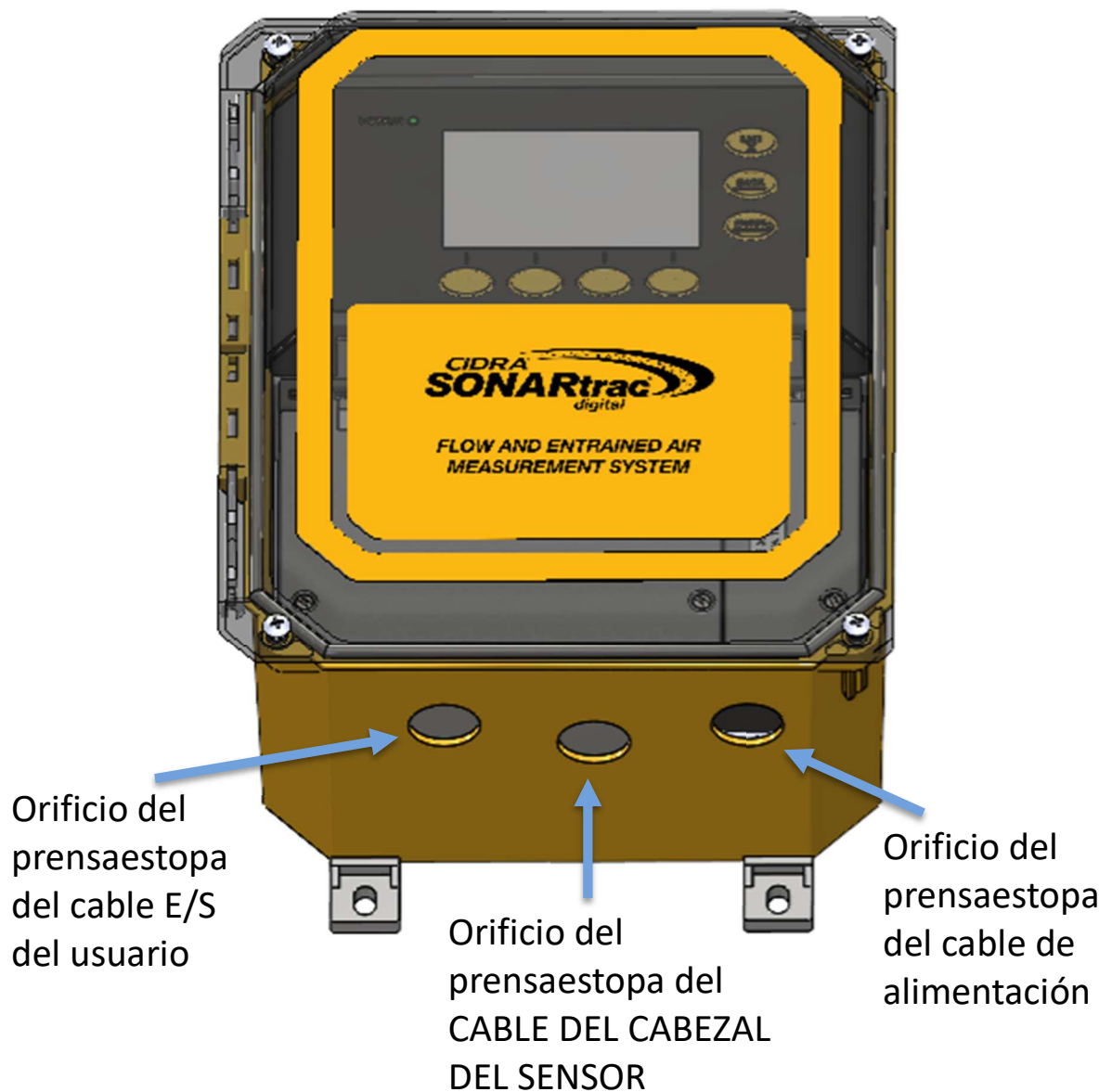
Figura 2-35: Los orificios para los prensaestopas de cables de la caja del TRANSMISOR
