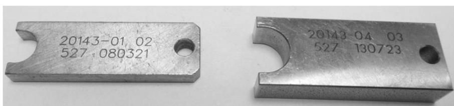
Galgas de calibración más comunes para la BANDA de sensores P/N 20143-01 (izq) y P/N 20143-04 (der)
