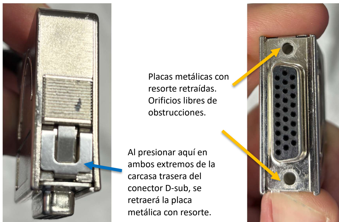
Figura 2-29: Desacople de los conectores D-sub
