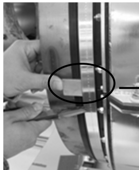
Figura 2-24: Instalación de la placa protectora de empalme
