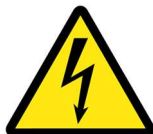
Figura 1-5: Símbolo de peligro de descarga eléctrica
