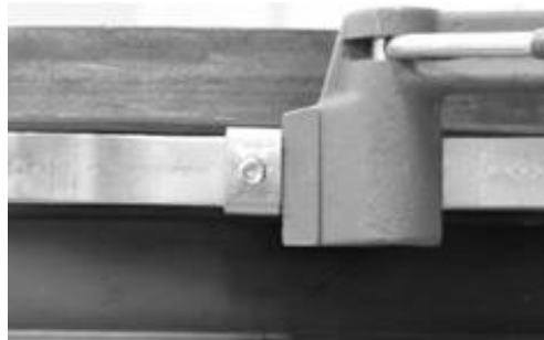
Figura 2-17: Uso de la herramienta tensora BAND-IT® modelo C00169
