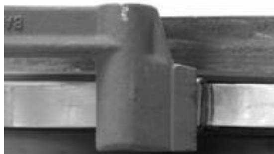
Figura 2-19: Herramienta BAND-IT® para doblar clips de retención
