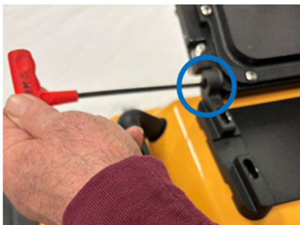
Figura 2-25: Desmontaje del MÓDULO DSE de la CUBIERTA
