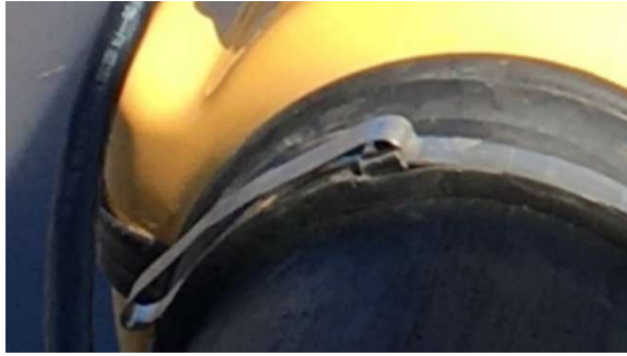
Figura 2-21: Instalación alternativa final del zuncho
