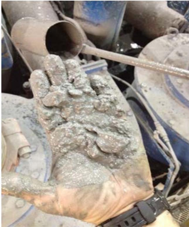
Figura 6 Durante la validación en terreno se analizaron 78 muestras de tamiz y se compararon con la contabilización de pebbles del OSM. Se muestra un ejemplo de material recolectado durante un paso de pebbles/piedras.
