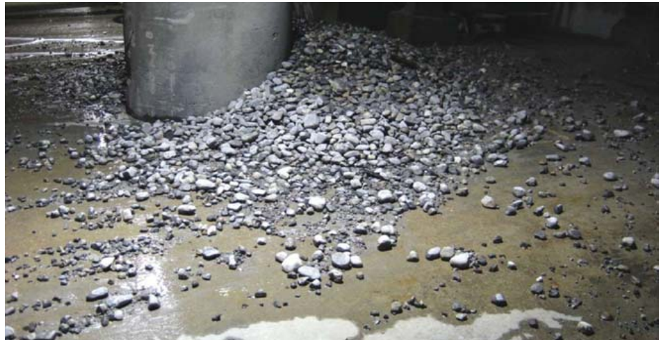
Figure 2—Roca descargada de una fila de rougher después de un importante evento de rocas.
