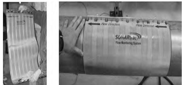
Figura 6 Fotos de la banda del sensor con elementos de sensor
