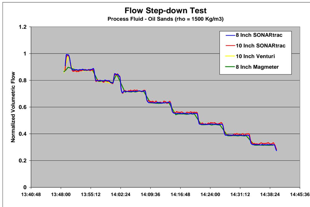
**Figure 18 Flow Step-Down Tests**
