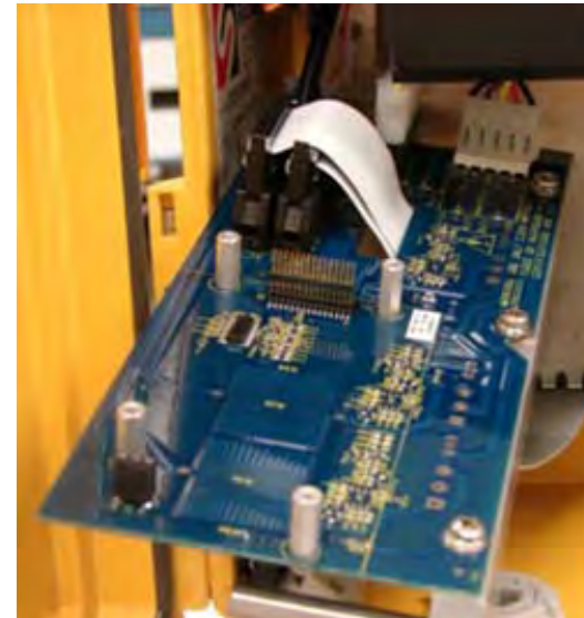
Figura 6 Tablero Fieldbus retirado
