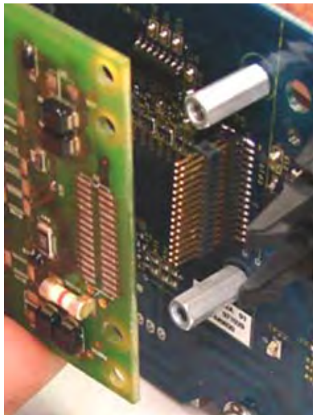
Figura 7 Instalación del nuevo tablero Fieldbus
