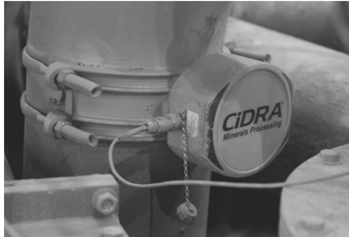
Figura 20: Cabezal del sensor montado en el tubo
