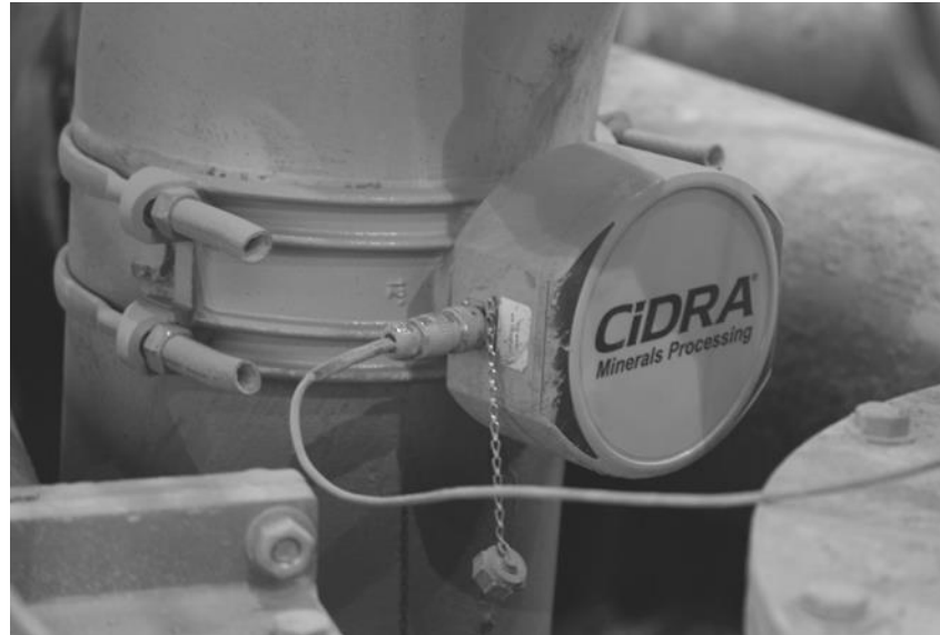
Figura 8: Cabezal del sensor montado
