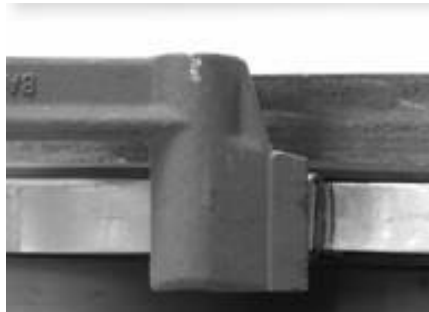
Figur 27 BAND-IT® -verktyget böjer över fasthållningsklämma
