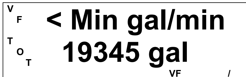
Figur 13 Flödes hastigheten är lägre än minsta konfiguration
