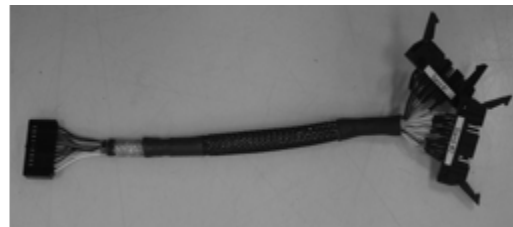
Figur 5 Närbild på 'Y'-anslutningsmontage
