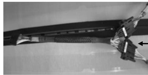
Figur 4 'Y'-anslutning kopplad till sensorbandanslutningar (P2 till band uppströms, P3 till band nedströms, P1 till för-först.)
