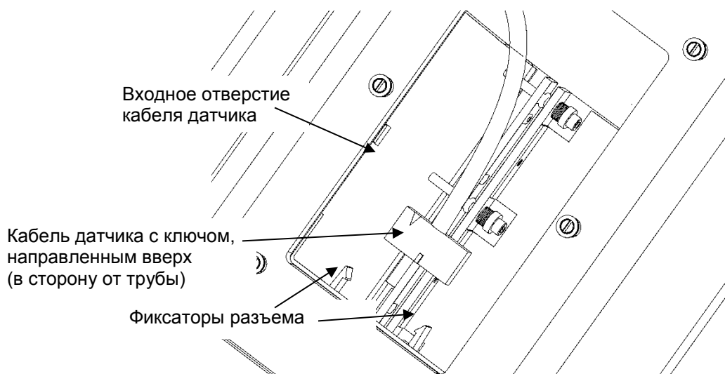
Рисунок 1 Отключение разъема кабеля датчика
