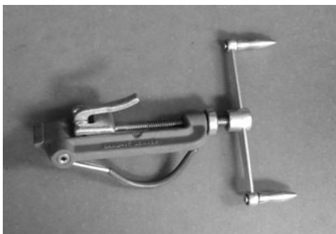
Рисунок 15 Приспособление для установки хомута BAND-IT® модель C00169
