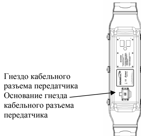
Рисунок 14 Кожух, установленный на вертикальной трубе, разъем снизу
