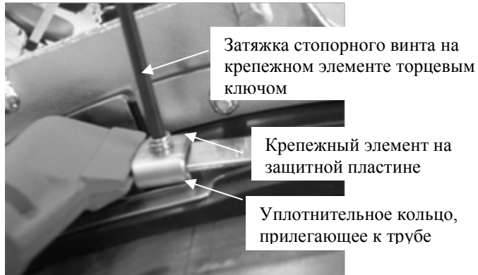
Рисунок 36 Заключительное выравнивание и закрепление уплотнительного кольца
