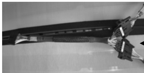
Рисунок 4 Y-образный разъем, подключенный к разъемам стяжного хомута (P2 хомут выше по технологическому потоку, P3 хомут ниже по технологическому потоку, P1 к преусилителю)
