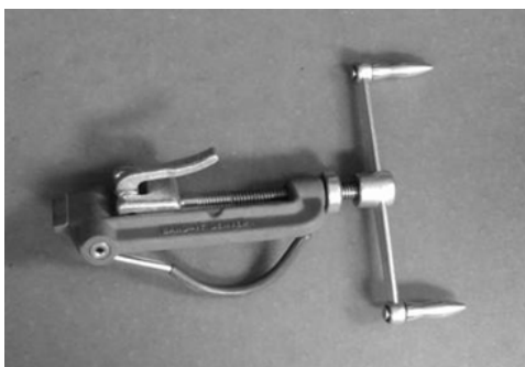
Рисунок 30 Приспособление для установки хомута BAND-IT® модель C00169
