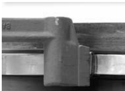
Рисунок 27 Инструмент для загибания BAND-IT®.
