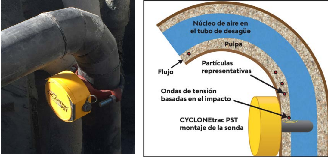
Figura 1 CYCLONetrac PST – Instalado en tubería de overflow (izquierda); ilustración del principio de operación (derecha)
