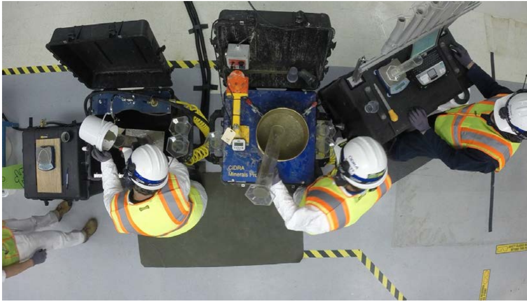
Figura 3 Vista superior de las estaciones de tamizado y análisis de pulpa por vía húmeda. En el centro se puede apreciar el agitador diseñado a la medida.
