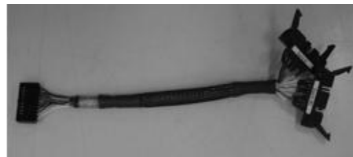
Figura 5 Ensamblaje del conector "Y" de cerca
